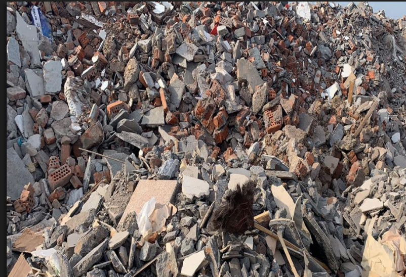
国内典型的拆除垃圾
