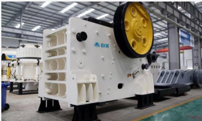
V型腔的设计，有效增加进料口，椭圆形运动轨迹，有效剥离混凝土中夹杂的钢筋，实现**筋砼分离**。
