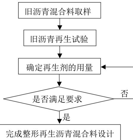
图1 整形再生沥青混合料设计流程
